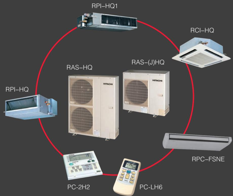
Полупромышленная серия Utopia применяется для охлаждения или нагрева больших помещений с возможностью подключения одного или двух внутренних блоков к одному наружному. Модельный ряд внутренних блоков представлен кассетными, канальными (высоконапорными), канальными (низконапорными) и подпотолочными блоками производительностью от 5,5 до 15 кВт.
