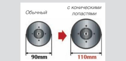
Сравнение диаметров. Вентилятор, лопасти которого имеют прямой край, потребляет больше энергии и создает шум.
