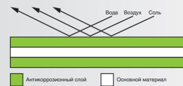
Теплообменник со специальным антикоррозийным покрытием служит в три раза дольше по сравнению с обычными. Это обеспечивает высокий КПД, надежность и сокращение издержек даже в таких сложных условиях, как эксплуатация в агрессивной природной среде: соленый морской воздух, резкие перепады температур, повышенная влажность и прочее.
