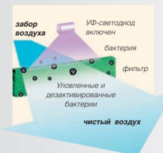
В природе бактерицидный ультрафиолет является частью солнечного спектра и обеспечивает баланс микроорганизмов в атмосфере и на земной поверхности. Специалисты Hitachi использовали метод УФ излучения, встроив УФ лампу во внутренний блок. Забираемый воздух, проходя через фильтр, очищается, а затем проходит обеззараживание коротковолновым ультрафиолетовым светом.
